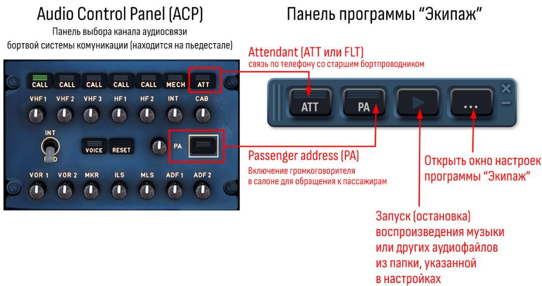
При нажатии на кнопку «ATT» или «PA» будет появляться телефонная трубка и варианты сообщений, соответствующих текущему этапу полета. Вы можете перемещаться по списку вариантов, выбирая один из четырех этапов полета кнопками на трубке.
